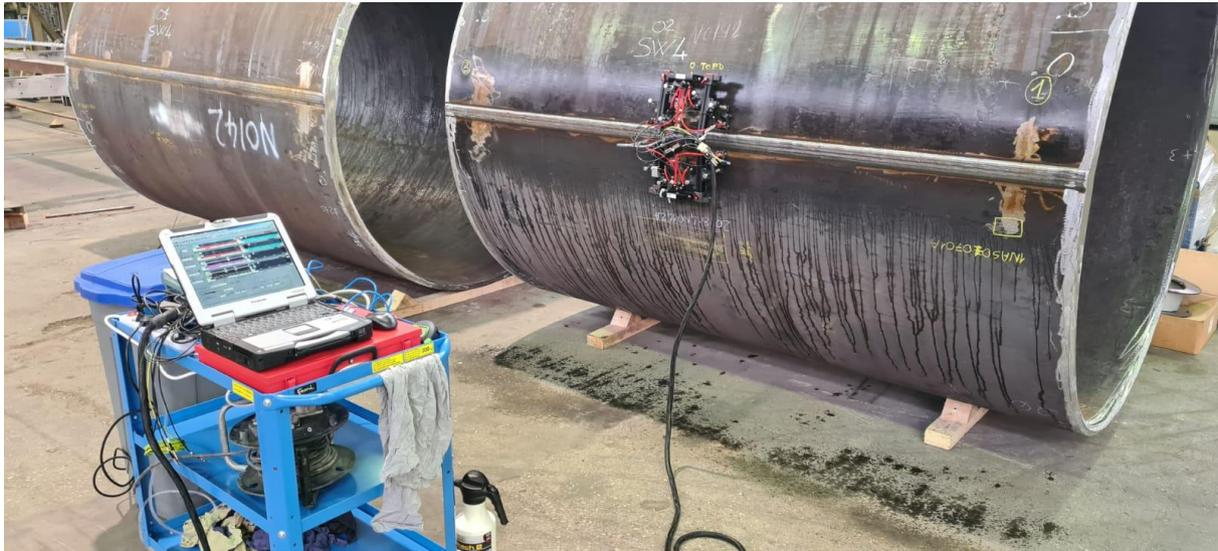
Il **PHASED ARRAY** è una tecnica avanzata ad ultrasuoni utilizzata per il rilevamento difetti, il loro dimensionamento e la creazione immagini/mappe.
